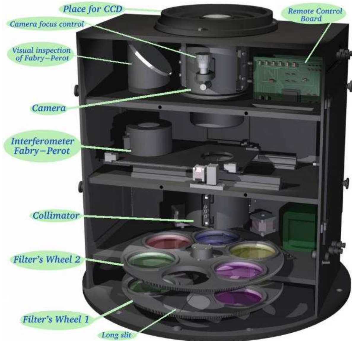
Рис. 1: Устройство редуктора светосилы
